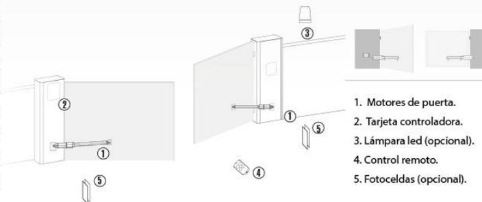
Incluye: dos motores (FC350), Un motor (FC351) una tarjeta electrónica y dos controles.
